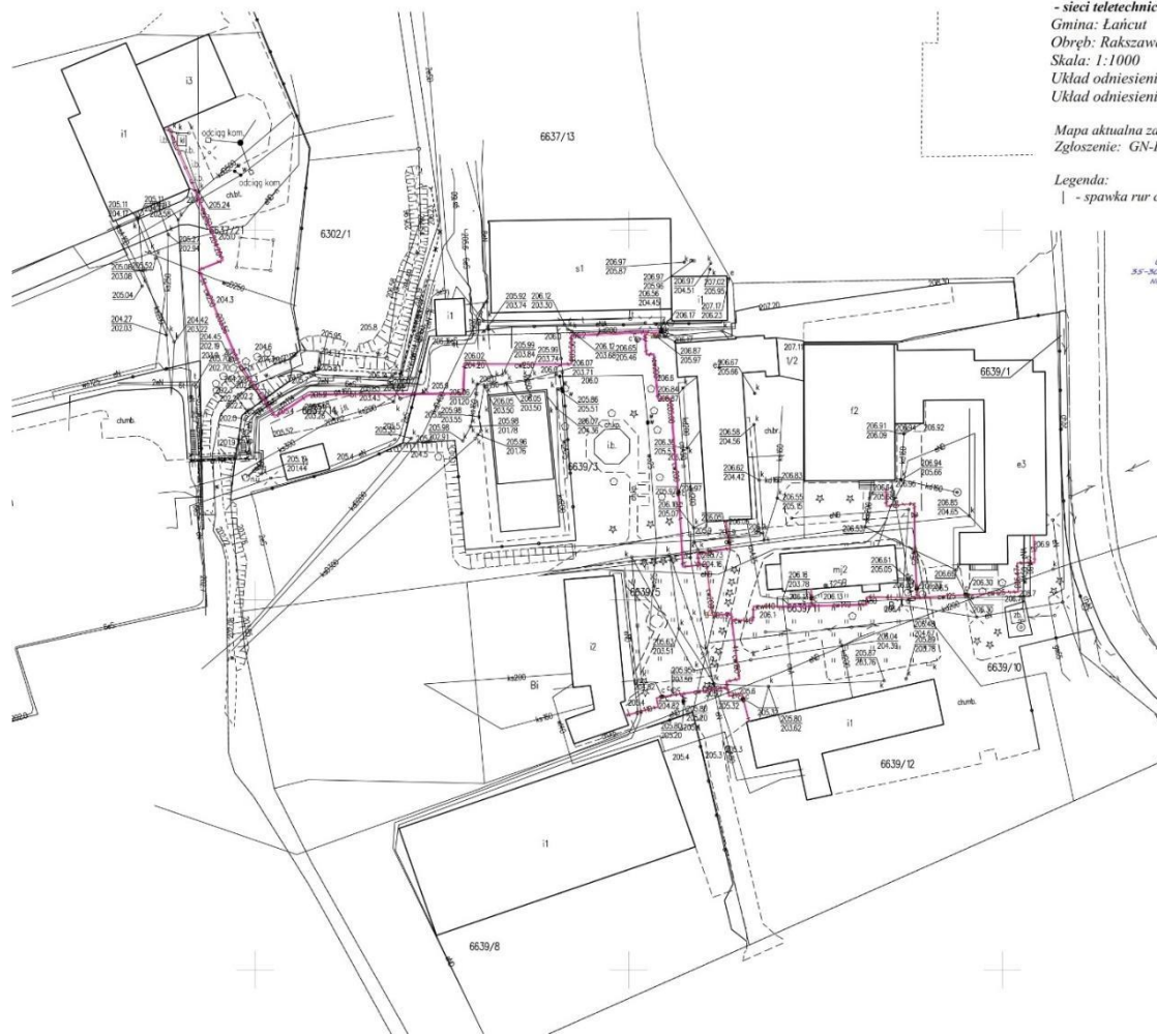
Rysunek 24. Inwentaryzacja powykonawcza, sieci ciepłowniczej wysokich parametrów stan na 2021r.
